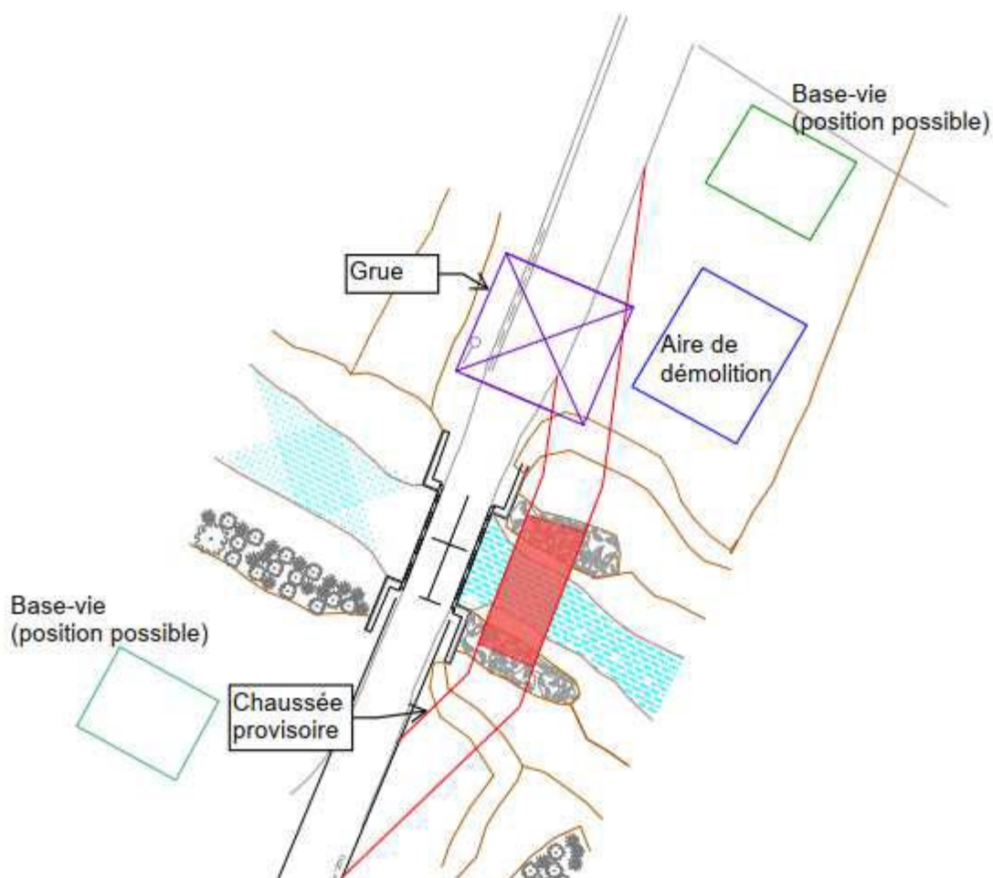
Figure 1 : Schéma d'installation du chantier - Source Ginger CEBTP
