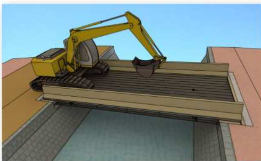
Exemple de pont provisoire
